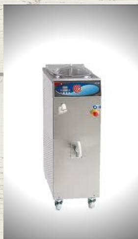
Tinox est la cuve de maturation qui offre la même ergonomie et les dimensions réduites que propose Pastmatic. Il permet de conserver constamment le mix à 4°C avant de commencer le procédé de congélation. Tinox est un refroidisseur efficace également pour refroidir le mix de 85°C à 4°C et de le conserver à cette température, permettant dans ce sens d'immédiatement vider le pasteurisateur et donc lui permettre de commencer un nouveau cycle de chauffe.
